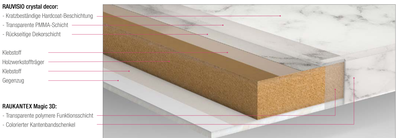
Abb. 7-1 Systemverbund RAUVISIO crystal decor composite mit Kante RAUKANTEX Magic 3D
